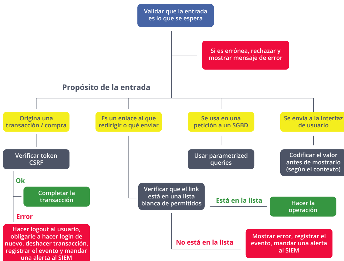
Figura 41. Algoritmo general de validación de datos
