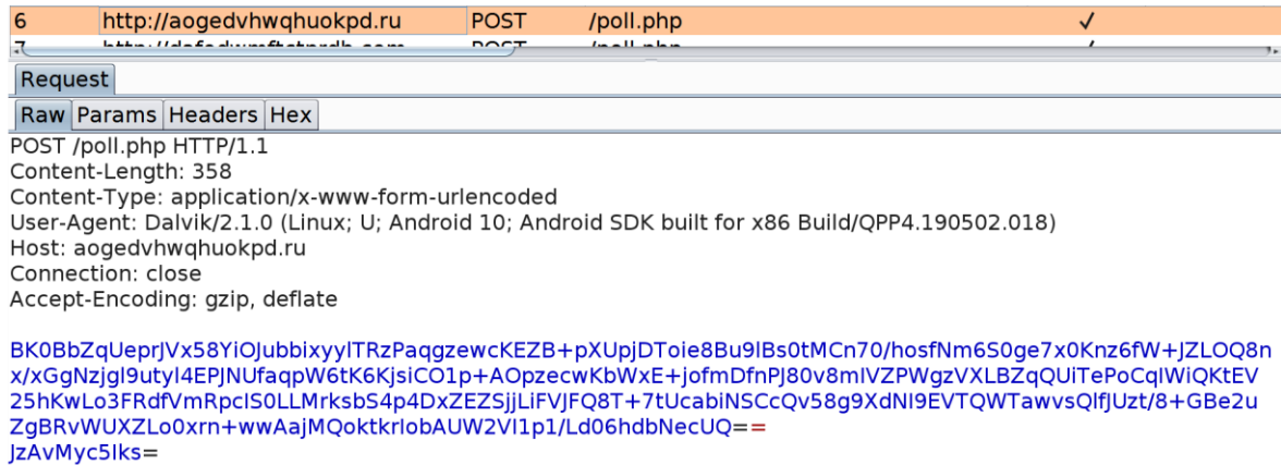
Ilustración 18. Ejemplo de petición enviada a uno de los dominios generados donde la primera cadena Base64 corresponde con el cifrado RSA y la segunda con el comando cifrado con XOR
