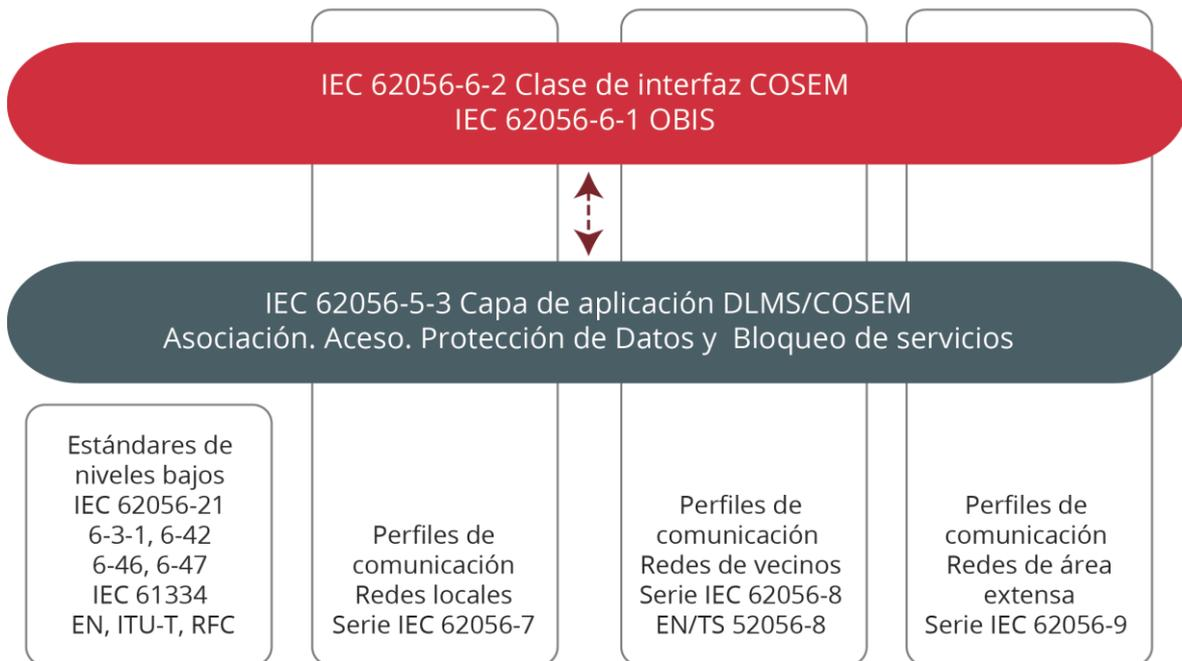
Figura 12. Arquitectura DLMS/COSEM. Fuente: DLMS
