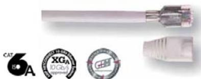
El latiguillo Categoría 6A estará diseñado usando conectores plug, cuyos contactos están bañados con 1,27µm de oro. El patrón de cableado estándar es el T568B. Está fabricado con cable Categoría 6A flexible con cubierta LSZH.
