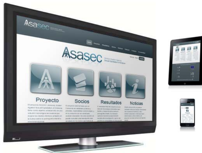
Figura 1. Asasec.eu : Ejemplo de Web con maquetación sensible (utilizando el estándar CSS Media Queries) adaptable a cualquier tipo de dispositivo.
